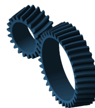
Hypoidradsatz mit Achswinkel < 90°
